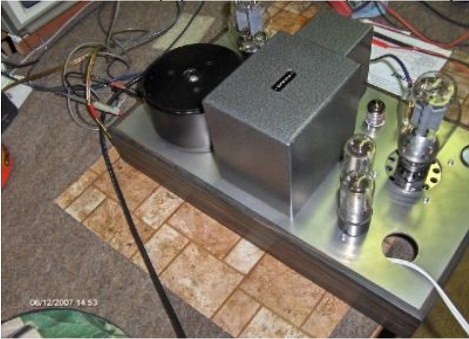
Widok na transformatory, tym razem zastosowaliśmy trafole uznanej firmy Tribute
